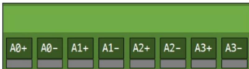
아날로그 입력은 3.5mm 간격의 8극 터미널 블록으로 4개의 포트가 제공됩니다. 각 포트는 ADC 디바이스 (ADC0/1/2)의 0 ~ 3번 채널에 맵핑되어 있습니다. 각 아날로그 입력 포트는 입력 유형을 지정해야 합니다. 해당 포트의 입력유형 선택 핀에 HIGH를 출력하면 전류방식(0 ~ 20mA), LOW를 출력하면 전압방식(DC 0 ~ 5V)이 됩니다.
